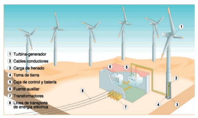
Figura 3.28. Producción de energía eólica
